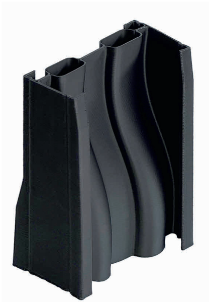
Bild 1. Mit dieser großformatigen Automobil-Mittelkonsole wurde die neue Simulationsmethode validiert. © M.TEC
